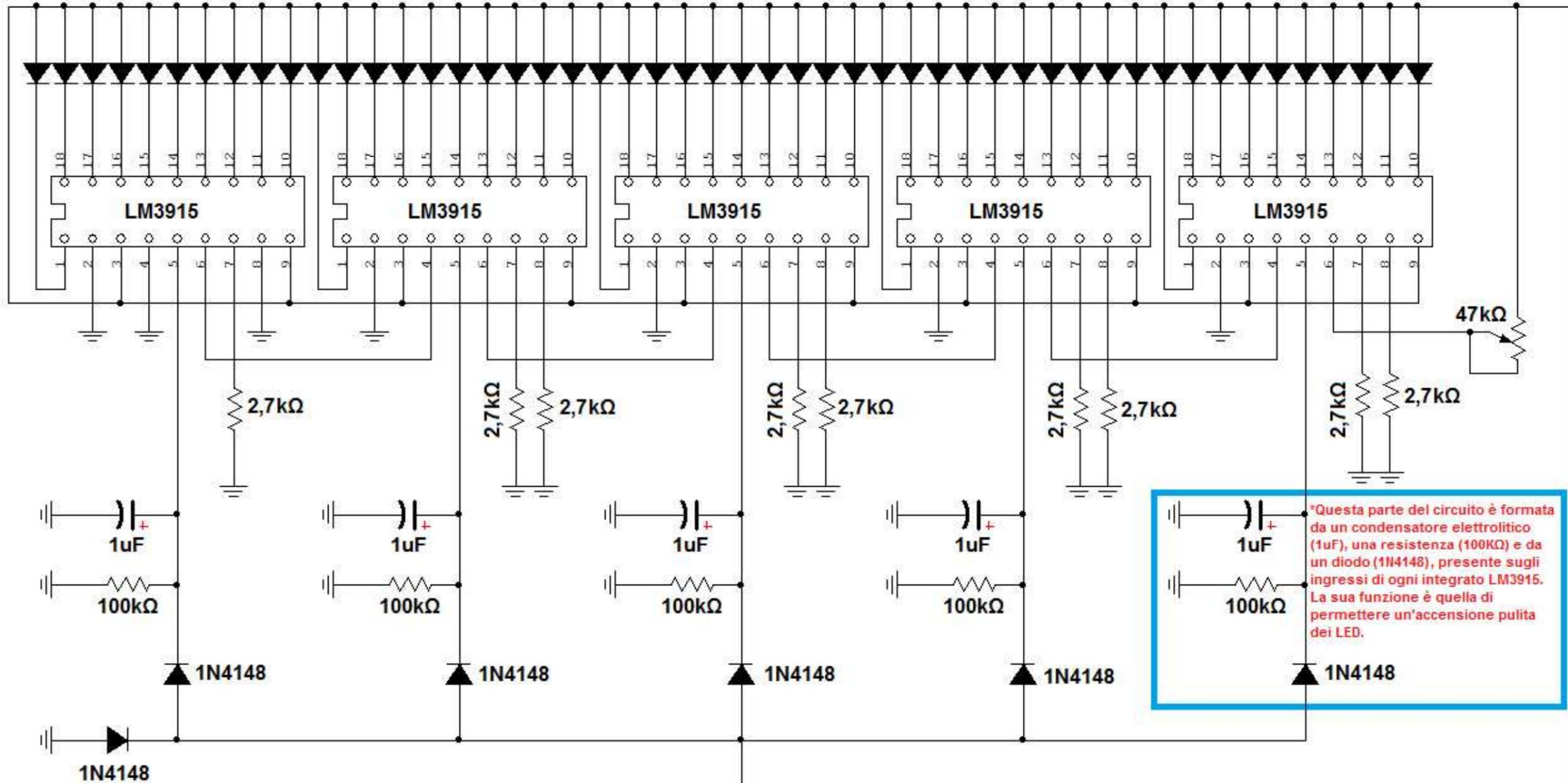
\*Questa parte del circuito è formata da un condensatore elettrolitico (1uF), una resistenza (100kΩ) e da un diodo (1N4148), presente sugli ingressi di ogni integrato LM3915. La sua funzione è quella di permettere un'accensione pulita dei LED.
